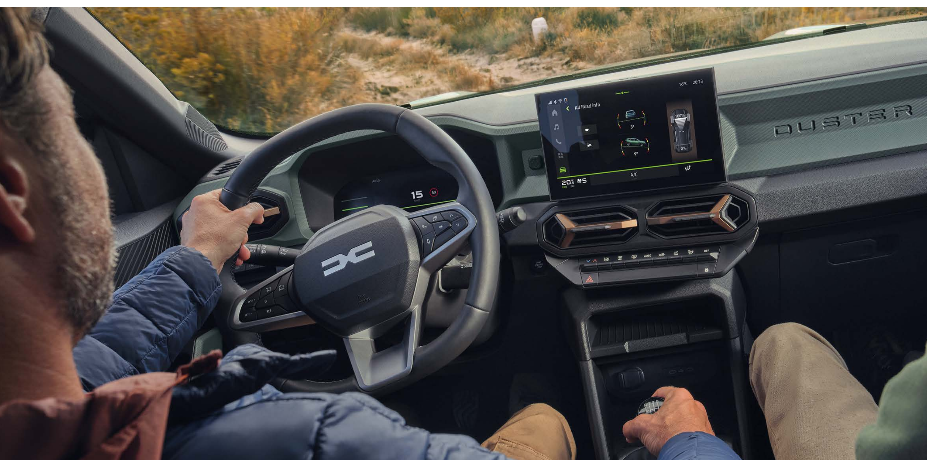
Pekskärm med 4x4 information: lutningsvinkel och kraftfördelning
